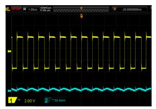
V<sub>IN</sub>=3V, V<sub>OUT</sub>=5V, I<sub>OUT</sub>=1A, CH1= V<sub>SW</sub>, CH2=ΔV<sub>OUT</sub>
